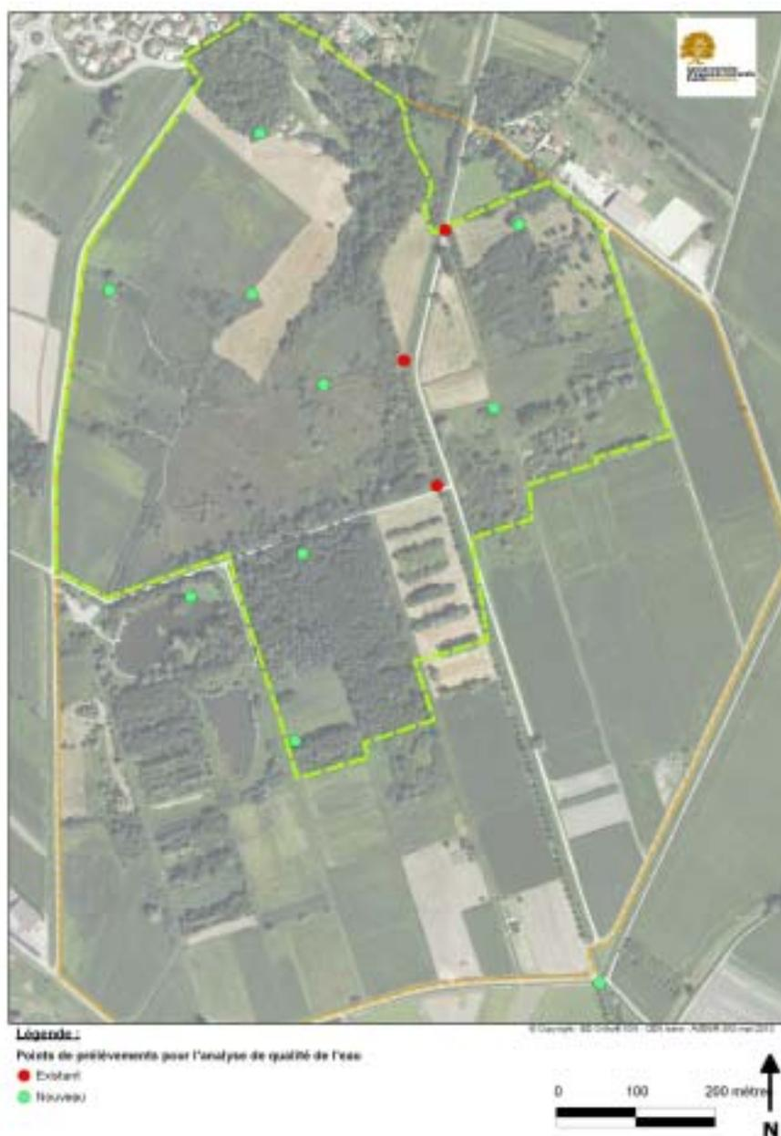
La mesure simultanée sur deux périodes (hautes eaux et basses eaux) de la qualité de l'eau, se fera à l'aide d'une sonde multi-paramètres de terrain permettant d'analyser la température de l'eau, la conductivité électrique, le pH, le potentiel d'oxydoréduction et l'oxygène dissout. L'objectif *in fine* est de suivre l'évolution des phénomènes d'eutrophisation qui ont pu être mis en évidence lors de l'étude hydrogéologique de 2012.
