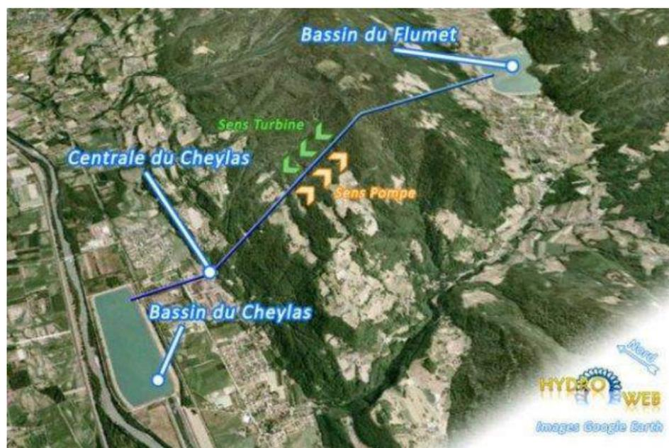
**Figure 38: Synthèse du fonctionnement de la centrale du Cheylas**
