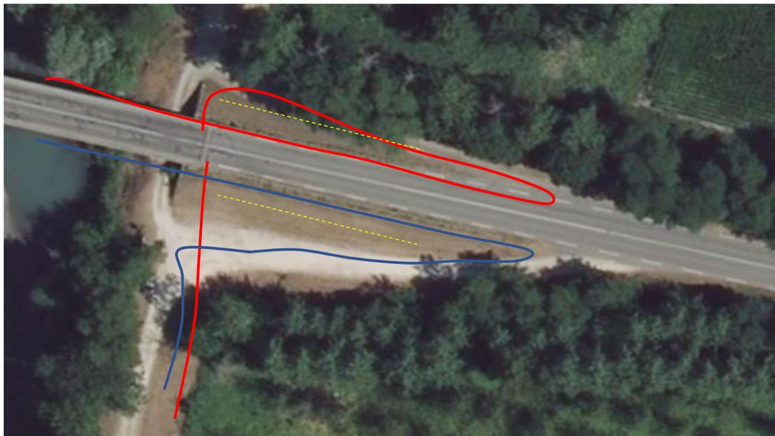
**Photo 9** : principe des rampes d'accès au pont depuis la digue Est.
